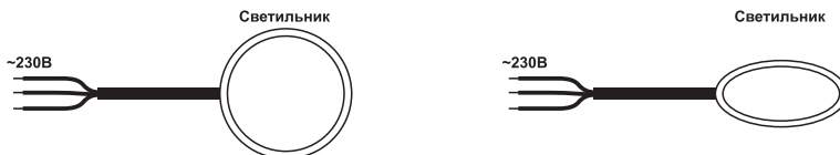
Подключение светильника к сети переменного тока 230В.
